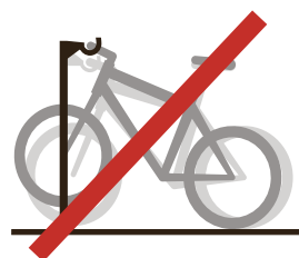
Lenkerhalter: Verbreitetes aber ungeeignetes Parkiersystem. Wird wenig benutzt und beschädigt Brems-, Licht- und Schaltkabel
