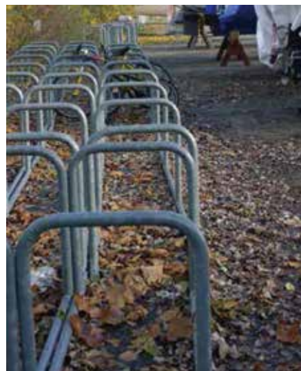
Mobile Anlehnbügel eines Freibades. Sie können im Winterhalbjahr anderweitig verwendet oder platzsparend angeordnet werden.
