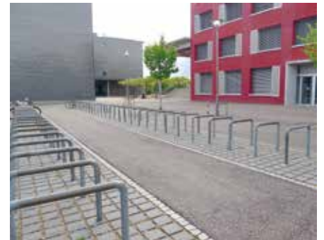
Anlehnbügel sind vandalensicher und einfach zu reinigen. Der Nachteil der fehlenden Überdachung wird bei dieser Anlage durch die optimale Lage wettgemacht
