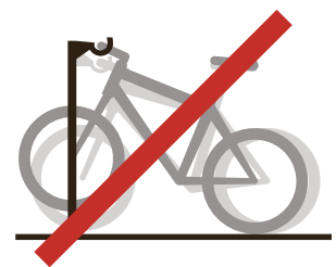
Lenkerhalter: Verbreitetes aber ungeeignetes Parkiersystem. Wird wenig benutzt und beschädigt Brems-, Licht- und Schaltkabel
